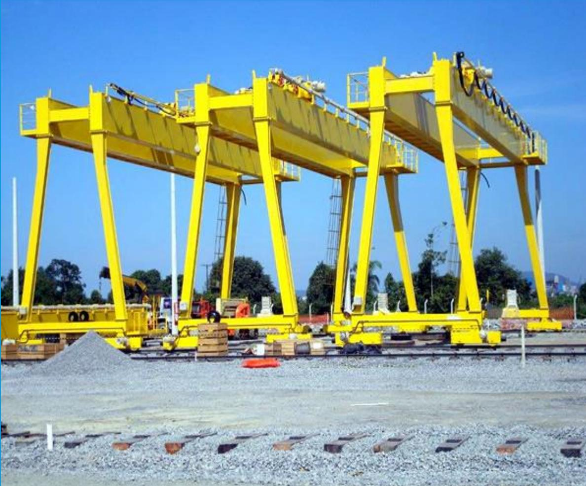
Os pórticos rolantes RS Manutenções Industriais se movem sobre trilhos montados sobre o piso de concreto, ou viga contínua, a carga de içamento do pórtico rolante é movimentada tridimensionalmente, limitada apenas pelo vão do equipamento, pelo comprimento do caminho de rolamento e pela altura de elevação.
