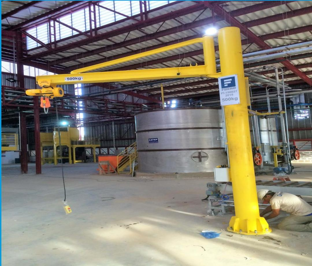
O braço giratório ou guindaste giratório é um equipamento perfeito para serviços de movimentação de cargas em áreas restritas, constituído com coluna fixa no piso ou na estrutura do galpão, com giro em opções manuais e elétricas de 180° a 360° graus, realizados de forma contínua ou limitada por batentes. É um recurso adaptável às mais variadas produções, sendo um ótimo custo-benefício para a sua empresa.
